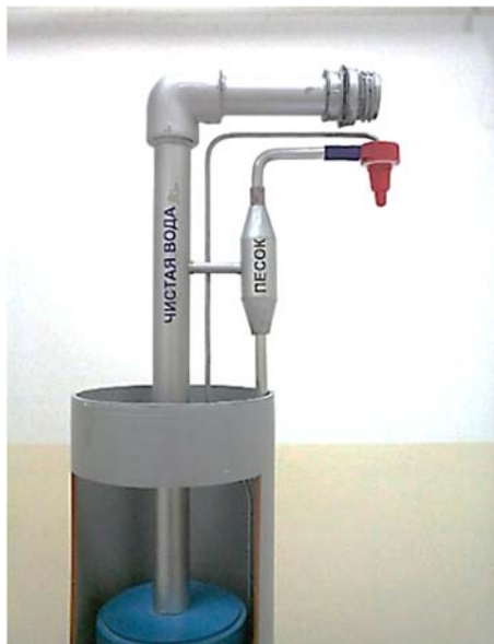
2-сурет - Салмалы контейнермен жабдықталған шахталы құдық (а) және гидроциклонды ЭЦВ типтес ұңғыма сорабы (б).
